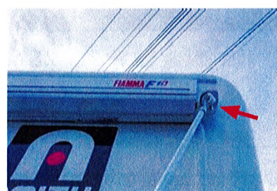
③ 右端のリングにボール先端のフックを引っかけます。
